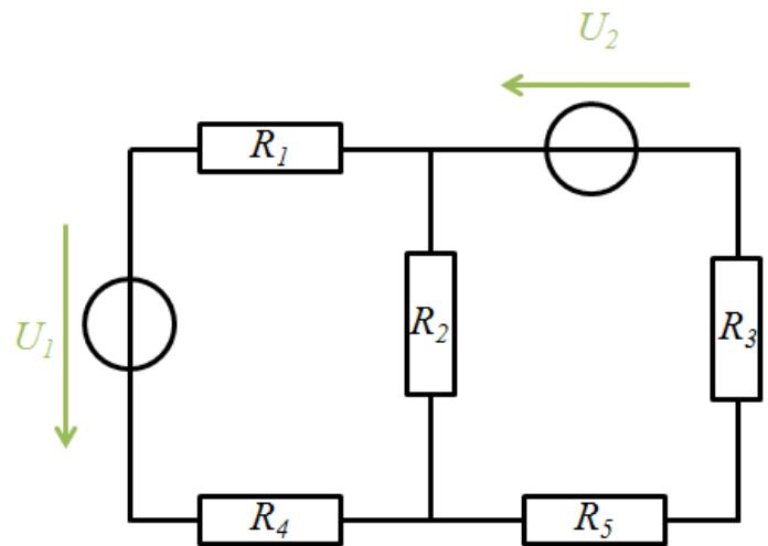
$$\begin{bmatrix} (R_1 + R_2 + R_3) & -R_2 \\ -R_2 & (R_3 + R_5 + R_2) \end{bmatrix} \begin{bmatrix} j_1 \\ j_2 \end{bmatrix} = \begin{bmatrix} U_1 \\ U_2 \end{bmatrix}$$
